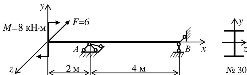
**Задача № 5.** Для балки, изготовленной из прокатного двутавра:
