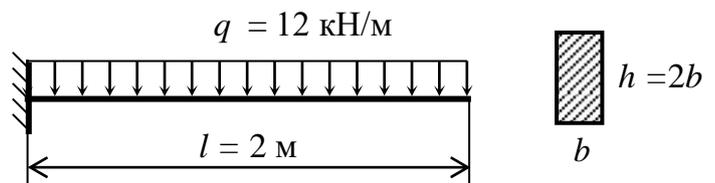
**Задача № 2.** Для стальной балки из условия прочности по нормальным напряжениям подобрать номер двутаврового сечения.
