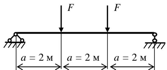
**Задача № 3.** На балку действуют две силы:  $F_1 = 12$  кН в вертикальной плоскости  $xu$  и  $F_2 = 8$  кН в горизонтальной плоскости  $xz$ . Из условия прочности при косом изгибе определить размеры прямоугольного сечения балки с соотношением сторон  $h/b = 2$ .
