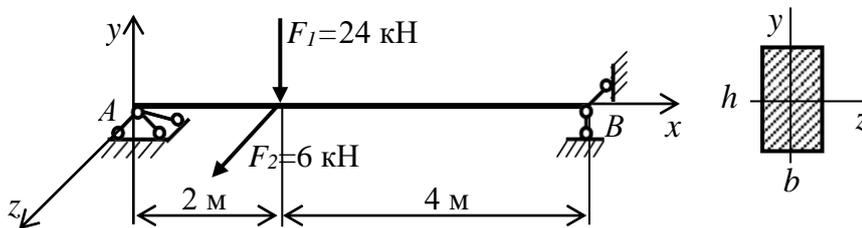
**Задача № 8.** Для вала механической передачи:
